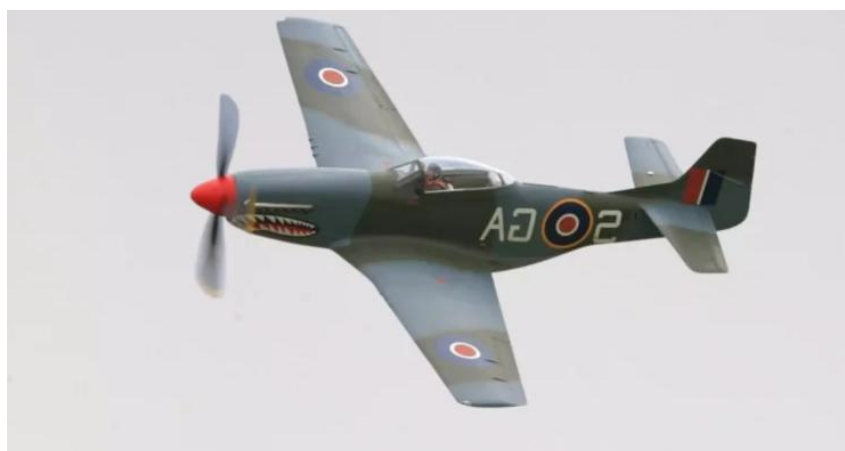
Слика 16: Авион са трапезним обликом крила П-51 Мустанг, [15]
