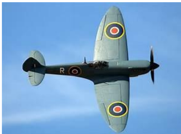
Слика 14: Авион са елиптичним обликом крила Супермарин Спитфајер, [13]
